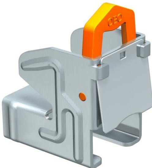
Graffa supporto con rivestimento antiruggine senza viti, con molla di ritenzione adatta per profilati tipo CML3518 e CMS 3518. Per il fissaggio rapido ai profilati d'acciaio in caso di montaggio di fasci di cavi, porta lampade, staffe reggicavo ecc. Il sistema completo è composto da 2 griffe di supporto e un profilato a C con lunghezza a scelta e da 2 calotte di protezione.
