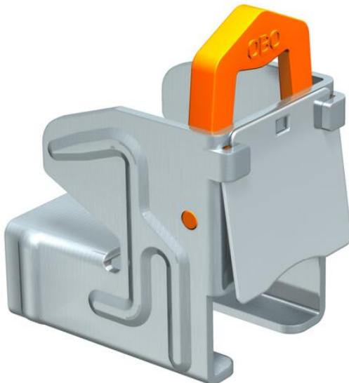
Atache pour poutrelle sans vis avec revêtement anticorrosion, avec ressort d'arrêt convenant aux rails profilés des types CML3518 et CMS3518. Pour la fixation rapide sur les profilés en acier lors du montage de chemins de câbles, de brides de fixation et de suspensions de luminaires, etc. Un système complet se compose de 2 pinces de fixation et d'un rail profilé en C d'une longueur quelconque et de 2 embouts de protection.
