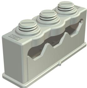
Solide Kabelbefestigung durch Klemmschrauben, mit Klebefuß, Langloch und zum Aufschrauben auf Gewinde M6. Zum Kleben der Polystyrol-Schellen auf Mauerwerk und Beton Impu-Fix-Stegleitungs-Schnellkleber Typ 509 verwenden.
