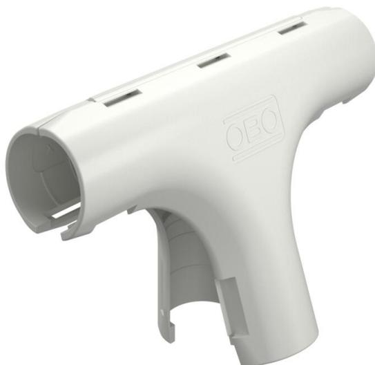
Élément préformé pour tubes d'installation électrique en matière plastique pour créer des dérivations en T. Convient aux tubes Quick-Pipe® ou gaines annelées. Fermeture et ouverture sans outils. Utilisation possible à des températures comprises entre -25 °C et +60 °C.
