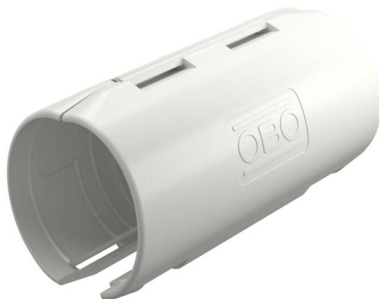
Verbindungsmaße für Elektroinstallationsrohre aus Kunststoff zum Erstellen von Längsverbindungen. Geeignet für Rohr Quick-Pipe® oder Wellrohre. Werkzeugloses Verschließen und Öffnen. Einsetzbar im Temperaturbereich von - 25° bis + 60° C.
