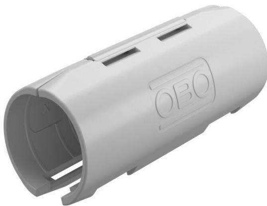
Manchon de raccordement pour tubes d'installation électrique en matière plastique pour créer des éclissages. Convient aux tubes Quick-Pipe® ou gaines annelées. Fermeture et ouverture sans outils. Utilisation possible à des températures comprises entre -25 °C et +60 °C.
