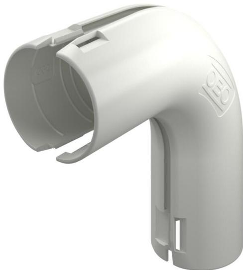
Élément préformé pour tubes d'installations électriques en matière plastique pour créer des coude à 90°. Convient aux tubes Quick-Pipe® ou gaines annelées. Fermeture et ouverture sans outils. Utilisation possible à des températures comprises entre -25 °C et +60 °C.
