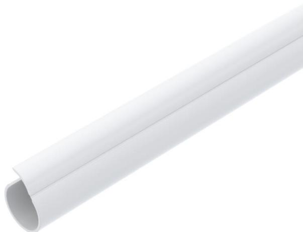
Tube ouvert Quick-Pipe® en plastique pour pose en saillie de câbles et conduites, en intérieur et dans un espace extérieur protégé. Montage mural et au plafond avec les colliers Quick, proQuick et Multi-Quick. Fermeture et ouverture sans outils par rotation dans le collier. Utilisation possible à des températures comprises entre -25 °C et +60 °C.
