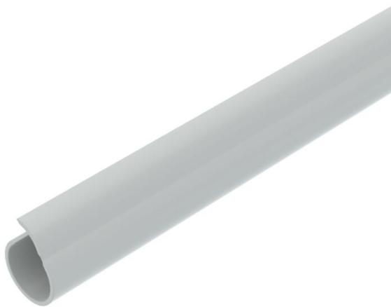
Offenes Rohr Quick-Pipe® aus Kunststoff zum Aufputz-Verlegen von Kabeln und Leitungen im Innen- und geschützten Außenbereich. Montage an Wand und Decke mit Quick-Schelle, proQuick-Schelle und Multi-Quick-Schelle. Werkzeugloses Verschließen und Öffnen durch Drehen in der Schelle. Einsetzbar im Temperaturbereich von - 25° bis + 60° C.
