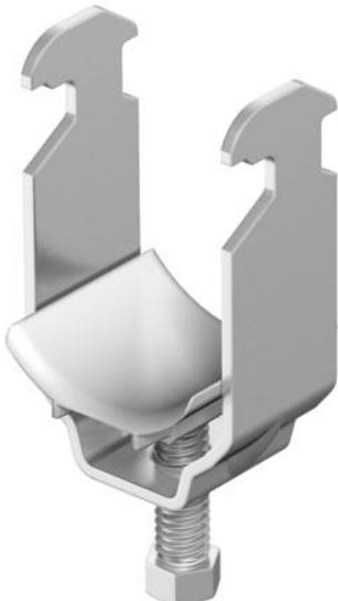
Adatta per tutti i profilati a C con larghezza delle asole compresa tra 16 e 17 mm; staffa e vite in alluminio ALMg 3, coppa premente in polipropilene, priva di alogenini, colore grigio chiaro RAL 7035.
