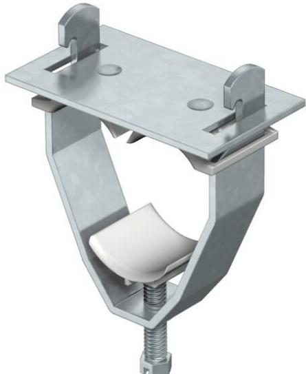
Corps du collier, vis et plaque d'écartement en acier galvanisé à chaud par trempage, patin de pression et contre-plaque en polypropylène, sans halogène, gris clair RAL 7035.
