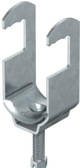
Convient pour tous les profilés métalliques ronds ou les tubes d'un diamètre max. de 22 mm. Bride, plaque de pression et vis sont en acier galvanisé à chaud.
