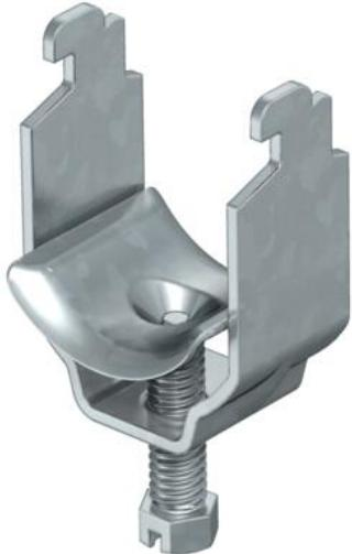
Adatta per tutti i profilati a C con larghezza delle asole compresa tra 11 e 12 mm con altezza interna libera di almeno 6,5 mm e larghezza interna libera di almeno 18,5 mm;
