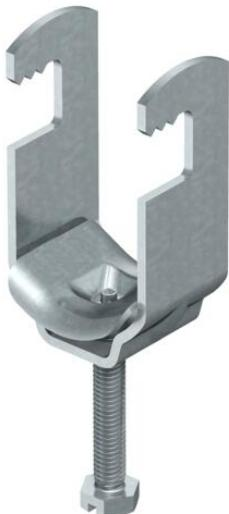
Bride de fixation pour la fixation de câbles et de tubes. Convient aux fers plats, coudés et en U de 4 à 12 mm d'épaisseur. Les patins de pression métalliques ont des arêtes et très arrondis sur toutes les faces pour éviter que les câbles soient endommagés.
