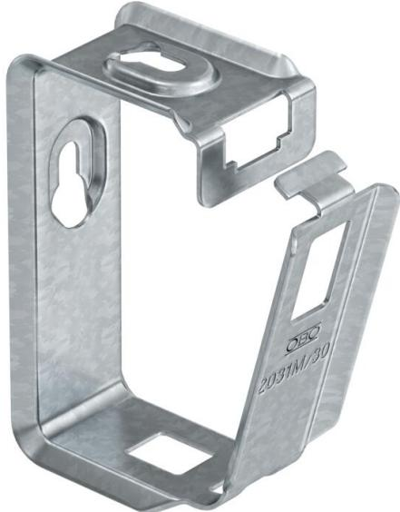
Sammelhalter aus Metall für hohe mechanische Standfestigkeit, auch im Brandfall. Zur sicheren Montage oberhalb von Brandschutzdecken geeignet. Auch als kabelspezifische Variante für den elektrischen Funktionserhalt nach DIN 4102 Teil 12 zugelassen. Für Wand- und Deckenmontage. Verschluss ohne Werkzeuge zu öffnen. Detaillierte Informationen der zugelassenen Verlegevarianten sind den entsprechenden Prüfdokumenten zu entnehmen.
