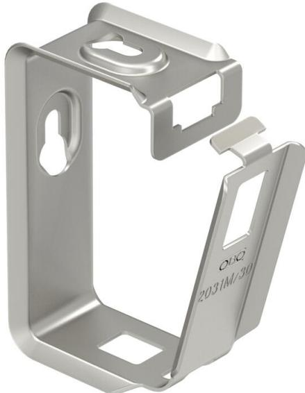
Sammelhalter aus Metall für hohe mechanische Standfestigkeit, auch im Brandfall. Zur sicheren Montage oberhalb von Brandschutzecken geeignet. Auch als kabelspezifische Variante für den elektrischen Funktionserhalt nach DIN 4102 Teil 12 zugelassen. Für Wand- und Deckenmontage. Verschluss ohne Werkzeuge zu öffnen. Detaillierte Informationen der zugelassenen Verlegevarianten sind den entsprechenden Prüfdokumenten zu entnehmen.
