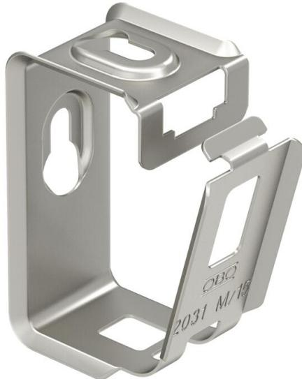
Sammelhalter aus Metall für hohe mechanische Standfestigkeit, auch im Brandfall. Zur sicheren Montage oberhalb von Brandschutzdecken geeignet. Auch als kabelspezifische Variante für den elektrischen Funktionserhalt nach DIN 4102 Teil 12 zugelassen. Für Wand- und Deckenmontage. Verschluss ohne Werkzeug zu öffnen. Detaillierte Informationen der zugelassenen Verlegevarianten sind den entsprechenden Prüfdokumenten zu entnehmen.
