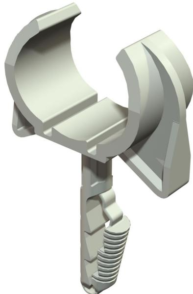
Mit angespritztem Steckdübel zur Schnellmontage in Betonwänden und Mauerwerk. Dübel bis zum Aufliegen der Schellenunterkante ins Bohrloch einstecken, beim Eindrücken des Rohres umgreifen die Schellenarme selbsttätig das Rohr.
