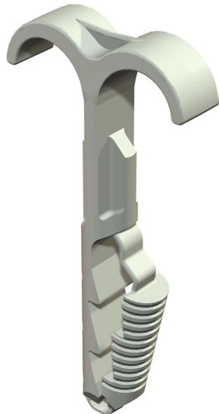
Les brides enfichables sont destinés à la pose de câbles et de tubes sur les murs et plafonds ainsi qu'à la pose de tubes flexibles sur les supports en béton et en plâtre. Les brides enfichables à double remplacent les clips de fixation à clou dans le béton et le béton cellulaire. L'avantage des brides enfichables est qu'ils doivent simplement être emboîtés dans le trou de montage. L'utilisation de chevilles et de vis devient alors inutile.
