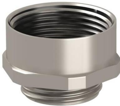
Espansione in ottone con filettatura interna ed esterna metrica per il montaggio di pressacavi in metallo o plastica in alloggiamenti. Grado di protezione IP54 senza guarnizione di collegamento supplementare. Possibile grado di protezione fino a IP68 con guarnizione di collegamento supplementare, ad esempio O-ring o guarnizione circolare piatta.
