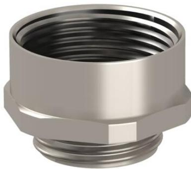
Espansione in ottone con filettatura interna ed esterna metrica per il montaggio di pressacavi in metallo o plastica in alloggiamenti. Grado di protezione IP54 senza guarnizione di collegamento supplementare. Possibile grado di protezione fino a IP68 con guarnizione di collegamento supplementare, ad esempio O-ring o guarnizione circolare piatta.
