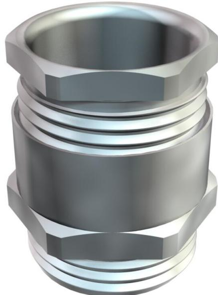
Kabelverschraubung mit Sechskant-Zwischenstutzen, Form C4 nach DIN 46320 mit metrischem Anschlussgewinde nach DIN EN 60423 bzw. ISO 68. Druckringe Stahl, galvanisch verzinkt und transparent passiviert. Dichtring aus NR/SBR. Schutzart: mit Anschlussgewinde-Dichtring IP65, ohne Anschlussgewinde-Dichtring IP54. Mit Einschnittring. \* Preise laut DEL-Notierung.
