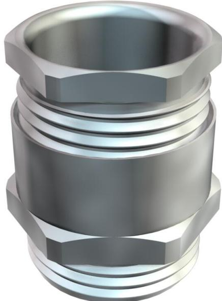
Presse-étoupe avec raccord intermédiaire à tête hexagonale, de forme C4 selon la norme DIN 46320 avec filet de raccordement métrique selon la norme DIN EN 60423 ou ISO 68. Bagues de pression en acier, galvanisées et passivées transparent. Bague d'étanchéité en NR/SBR.
