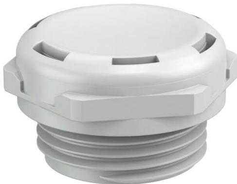
Das Druckausgleichselement Typ 109 M20 LGR gleicht Druckunterschiede in Kabelabzweigkästen, Kleinverteilern und Verbindungsboxen mit M20-Öffnung aus und vermeidet die Bildung von Kondenswasser in abgedichteten Gehäusen. Das Druckausgleichselement aus Polyamid hat die Schutzart IP68/IP69. Diese bleibt auch nach der Installation des Druckausgleichselementes bestehen. Das Druckausgleichselement ist für den Einsatz in industriellen Umgebungen und im Außenbereich geeignet.
