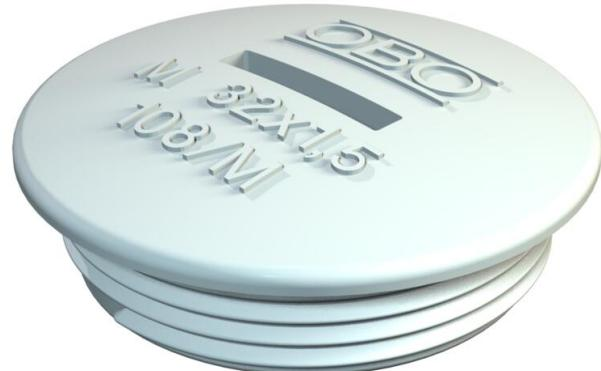
Verschlusschraube nach DIN 46320 mit metrischem Gewinde nach IEC 423. Schutzart IP54, IP68 (5 bar/1h) in Verbindung mit Dichtungsring Typ 171 möglich.
