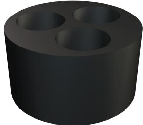
Einsatz zum Einführen mehrerer dünner Leitungen in die V-TEC-Kabelverschraubungen, wird gegen den einfachen Dichtring der Kabelverschraubung ausgetauscht.
